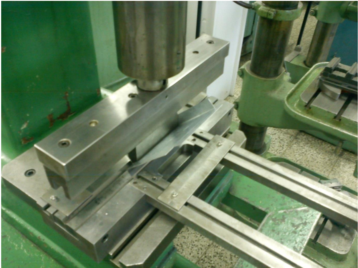
Ohýbání elektroinstalačních krabic
